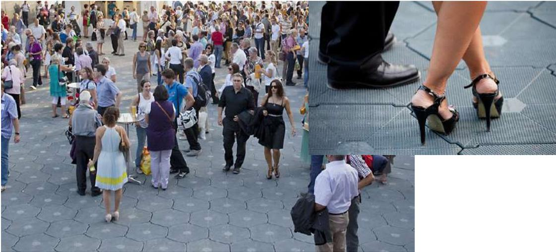
Belastbar, strapazierfähig und wetterfest für die temporäre Abdeckung von Festgelände und Ausstellungsflächen. Die Sechseck-Verbundplatten aus Kunststoff lassen sich leicht und schnell verlegen für saubere und ebene Gehflächen. Pro m<sup>2</sup> Bodenfläche werden ca. 4 Platten benötigt, das Plattengewicht beträgt ca. 3 kg.
